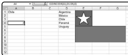
**FIGURA 23.** La función de la celda A4 muestra el número de orden del país seleccionado en la celda A1, dentro de la lista del rango D1:D5.
